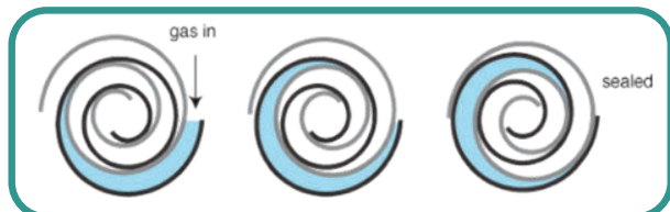
شکل شماره ۴: نحوه ی مکش و فشرده سازی هوا در پمپ های خلاء پیچشی
