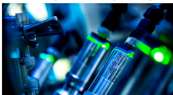
شکل ۳: خودکالیبراسیون سنسور دما نصب شده بر روی اتوکلاو
