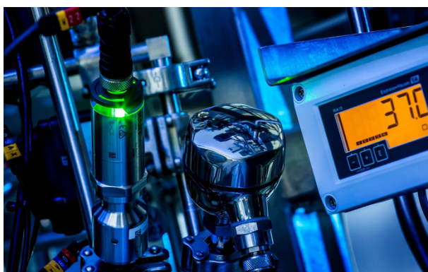
شکل ۱: سنسور دمایی خود کالیبراتور نصب شده بر روی اتوکلاو
