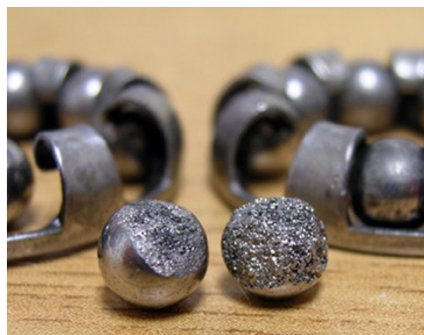
شکل شماره ۲: خوردگی گوی ها به دلیل اصطکاک و عدم روانکاری
