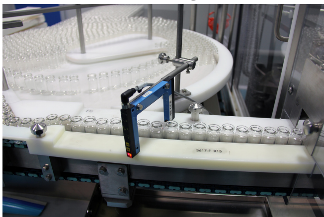
شکل شماره ۱- سنسور نوری ماشین ویال شویی شرکت داروسازی آفاشیمی برای تشخیص وجود ویال بر روی کانوایر
